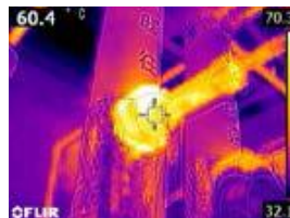
サーモグラフィーによる断熱改修箇所の特定
